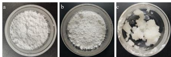
a-二氧化硅 b-挥发油-二氧化硅 (1:5) c-挥发油-二氧化硅 (2:5) a-silicon dioxide b-volatile oil-silicon dioxide (1:5) c-volatile oil-silicon dioxide (2:5)
